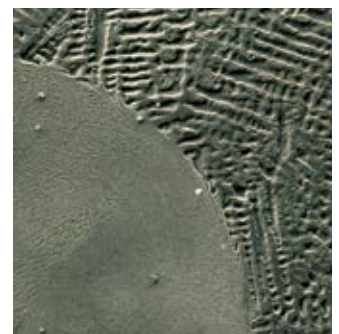
Rissfreie Lasernaht bei einer kohlenstofffreien CoCrMo-Modellguss-Legierung
