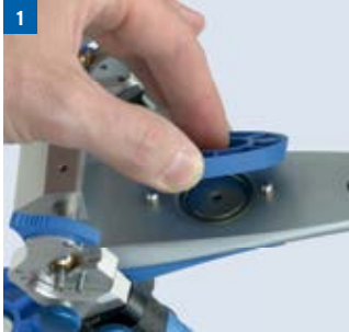
1 Modellplatte, Magnet und Magnettopf aus Artex-Ober- und Unterteil entnehmen
