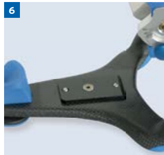
6 Klebeplatte in Artex-Unterteil einschrauben
