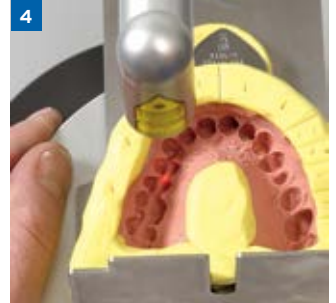
4 Bohrlloch positionieren mit Hilfe des Laserpunktes und Bohrvorgang auslösen
