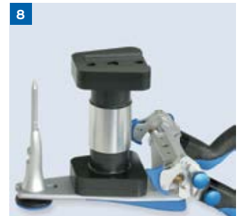
8 Splitex-UK-Platte auf Schlüssel aufsetzen
