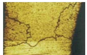
Grobkörniges Gefüge einer herkömmlichen CoCrMo-Aufbrennlegierung (V=100:1)
