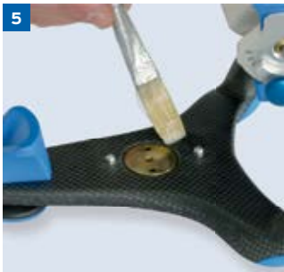
5 Carbonfläche im Bereich der Klebeplatte mit dünner Schicht Vaseline isolieren
