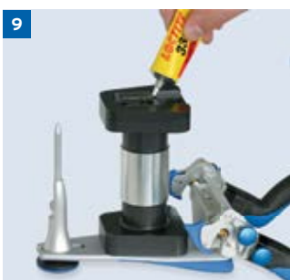
9 Splitexplatte mittig mit zwei Kleberspuren versehen
